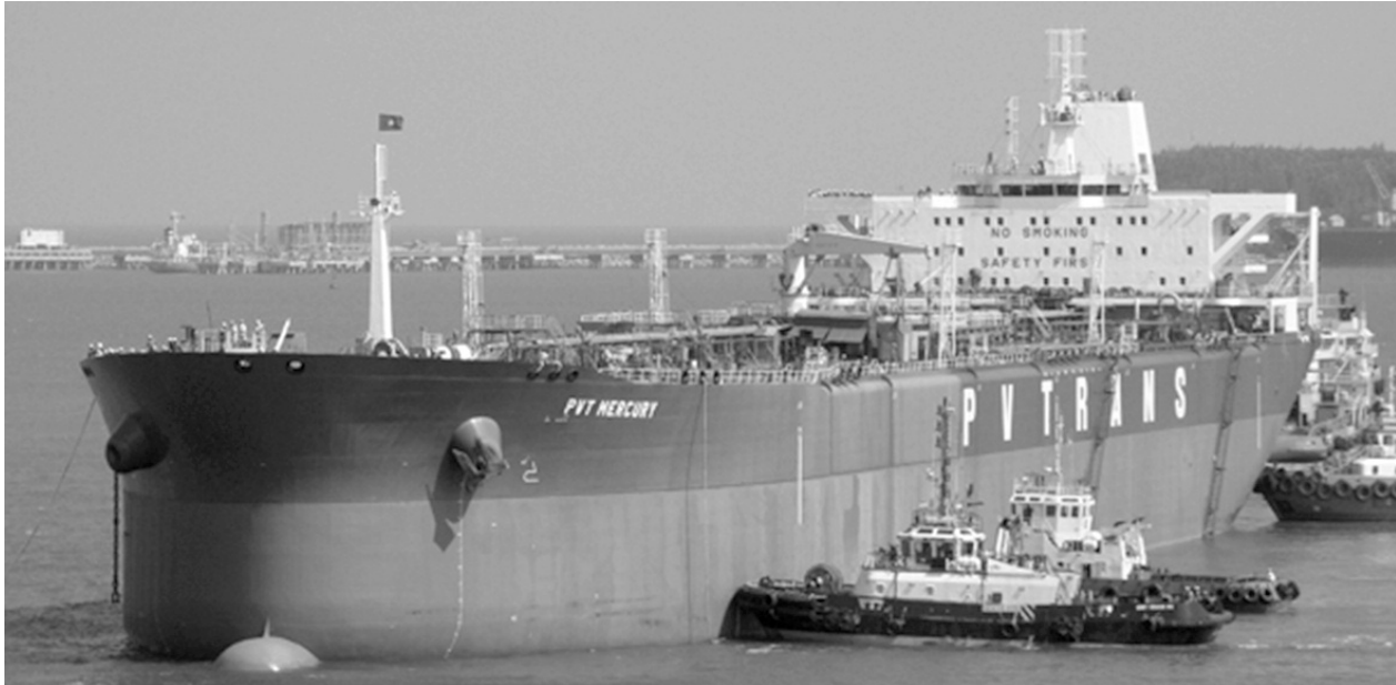
● Tàu chở dầu thô 104.000DWT do Công ty Công nghiệp Tàu thủy Dung Quất (đơn vị của Tập đoàn Dầu khí Quốc gia Việt Nam) đóng mới.
